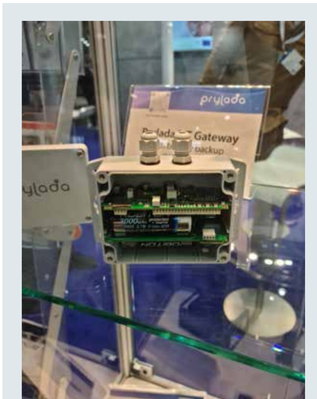
Prylada, een Poolse IoT gateway waar verschillende sensoren op aangesloten kunnen worden en die naar keuze met NB-IoT of LTE-M zijn data verstuurd.
